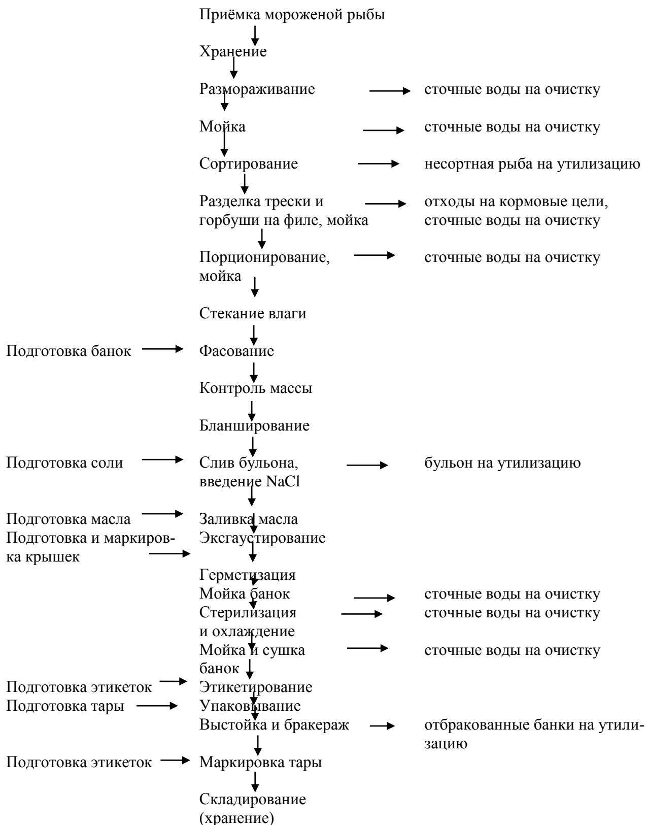
Рис. 2.1 Технологическая схема производства консервов «Горбуша бланшированная в масле грецкого ореха»
